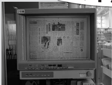
マイクロリーダー。マイクロフィルムを映す専用の機器。拡大や白黒反転にも対応しています。
